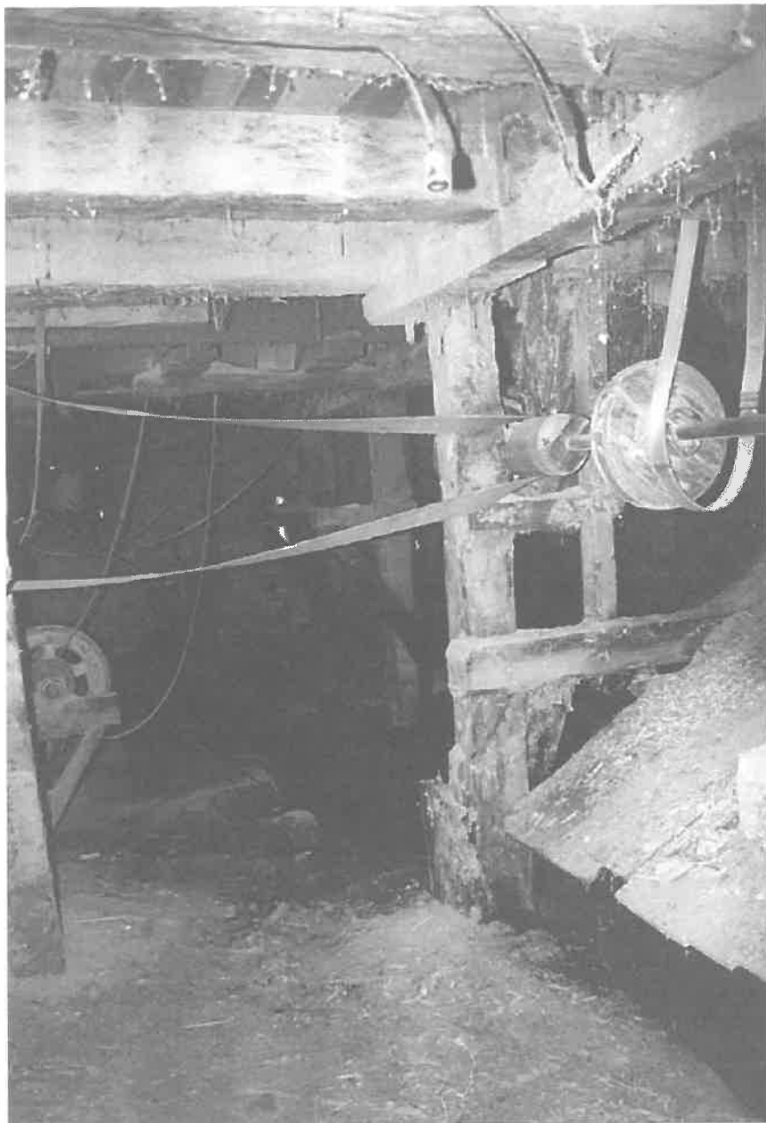
Φωτογρ. 8. Το σύγχρονο σύστημα των τροχαλίων και των ιμάντων που μεταδίδουν την κίνηση σε διάφορα μηχανήματα Νεροπρίοιο του Ζαρκάδι στο Μέτσοβο.
